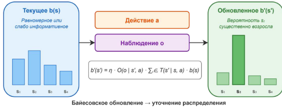
Рисунок 3. Схема байесовского обновления состояния веры Figure 3. Bayesian belief state update scheme
