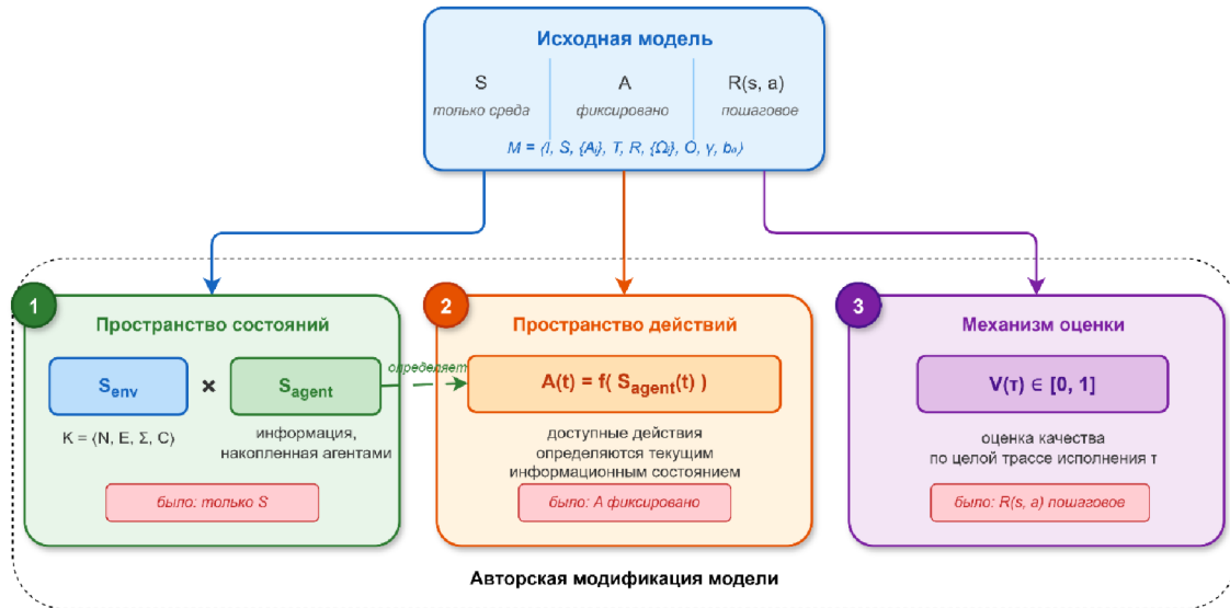
Рисунок 6. Авторская модификация модели децентрализованного частично наблюдаемого марковского процесса принятия решений
